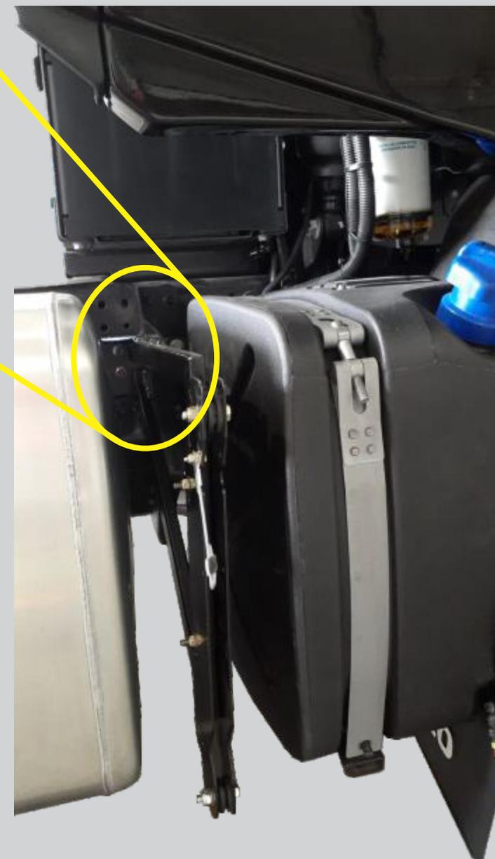
Décimo passo: Instalar o item 1.1 no chassis unindo ao item 1.2 e 1.3 no local destacado na imagem, utilizando
