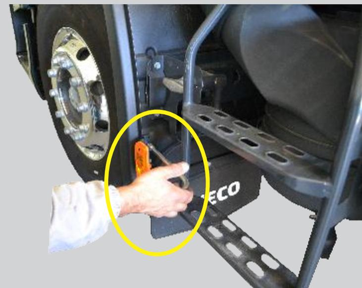
Quarto passo: Retirar o suporte e a sinaleira traseira, o suporte não será mais utilizado. Os parafusos originais devem ser recolocados no local para fixar o para-lama.
