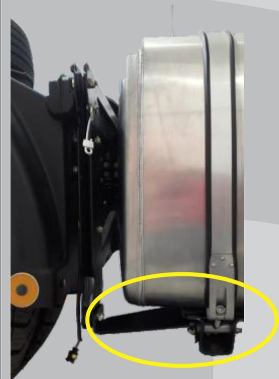
Décimo segundo passo: Instalar o item 1.4 no item 1.5 e no suporte do tanque no local destacado na imagem, utilizando:
