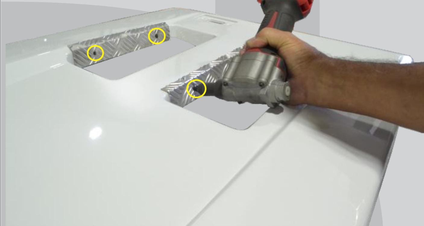
Décimo nono passo: Instalar o item 2 no caminhão unindo os itens 2.3 no item 2.8 e os itens 2.4 e 2.6 na parte inferior e na parte superior fixar a linga cabo de aço nos mesmos, utilizando:
