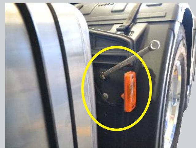
Quinto passo: Instalar o item 2.7 na escada e no para-lama nos locais destacados na imagem, utilizando:
