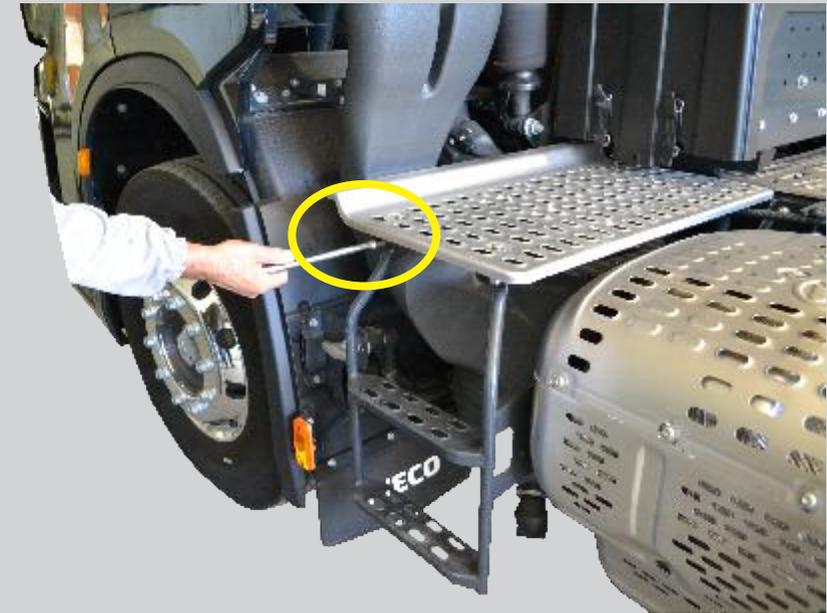
Segundo passo: Retirar os parafusos do suporte que fixa o para-lama da cabine, os mesmos não serão mais utilizados.
