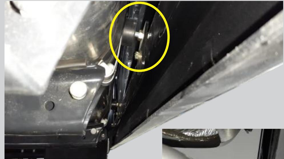
Vigésimo primeiro passo: Centralizar, regular e apertar os itens 1.8 e 2.5 para que fiquem todos devidamente centralizados na cinta de sustentação do tanque.
