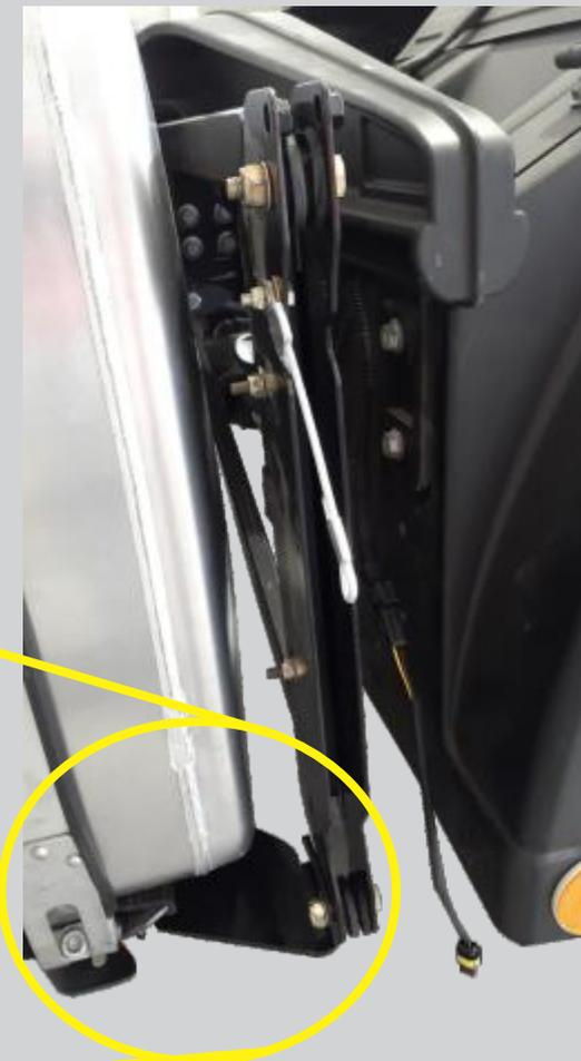
Iniciar a montagem no lado direito, retirando o *catwalk* para facilitar o acesso a parte interna do chassis e montar o suporte dianteiro.
