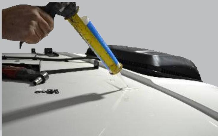
Retirar os parafusos originais na região superior da cabine e vedar o local, utilizando:
