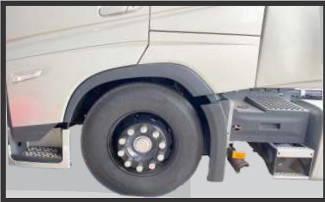
**02.** Antes de fixar o novo para-lama, posicione-o corretamente no lugar onde o antigo estava. Verifique o alinhamento para garantir que o para-lama se encaixe perfeitamente no suporte ORIGINAL.
