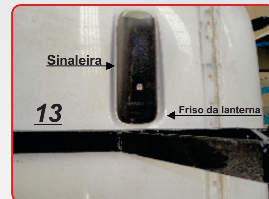
Posicionamento do rack no friso da lanterna.
